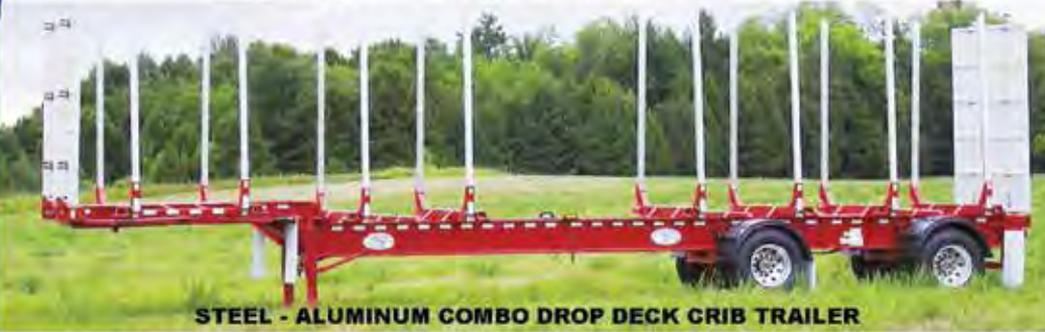
**STEEL - ALUMINUM COMBO DROP DECK CRIB TRAILER**
